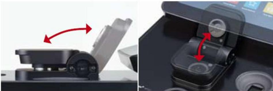
測定部はサンプルを挟み込み(密閉空間)測定するので、蒸発や表面張力の影響の少ない測定が可能です。
